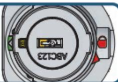
tournez la poignée dans le sens des aiguilles d'une montre jusqu'à la position „ouvert“.
