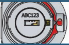
Tournez la poignée dans le sens inverse des aiguilles d'une montre jusqu'à la position „verrouillé“.
